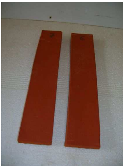
Obr. 2.: Skúšobné vzorky pred zmrazovacími cyklami
