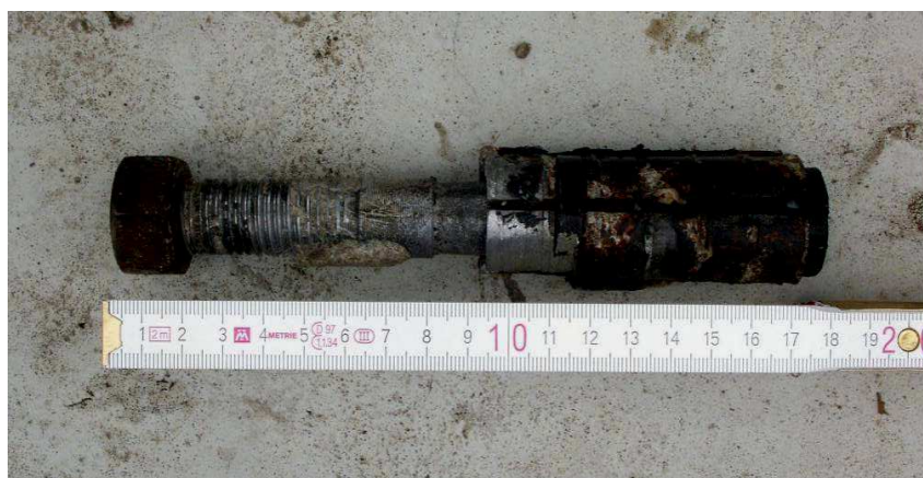
Obr. 11.: Ověření délky kotevního šroubu.
