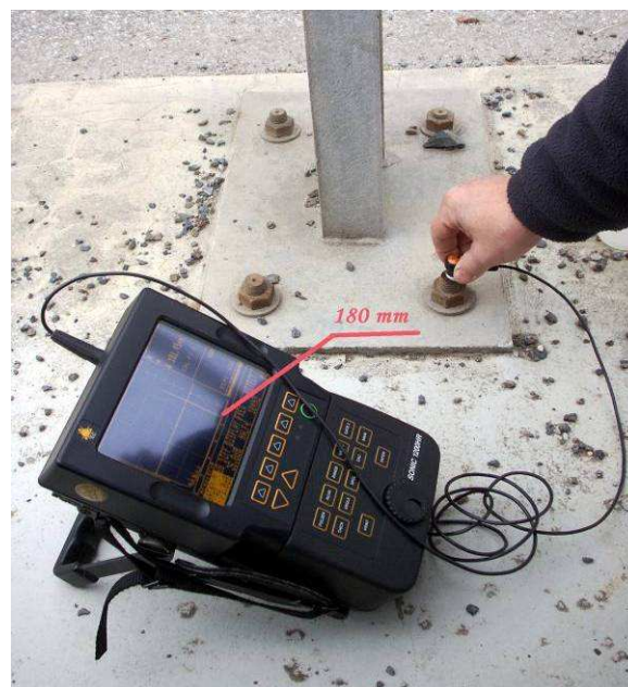
Obr. 10.: Kontrola délky kotevních šroubů ultrazvukem
