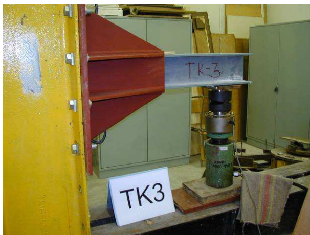
Obr. 10: Realizace zkoušek sloupků pro protipovodňovou stěnu – tělesa TK
