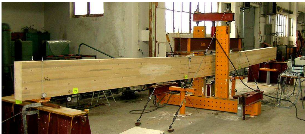
Obr. 2.: Skúšobné zariadenie a nosník počas experimentu
