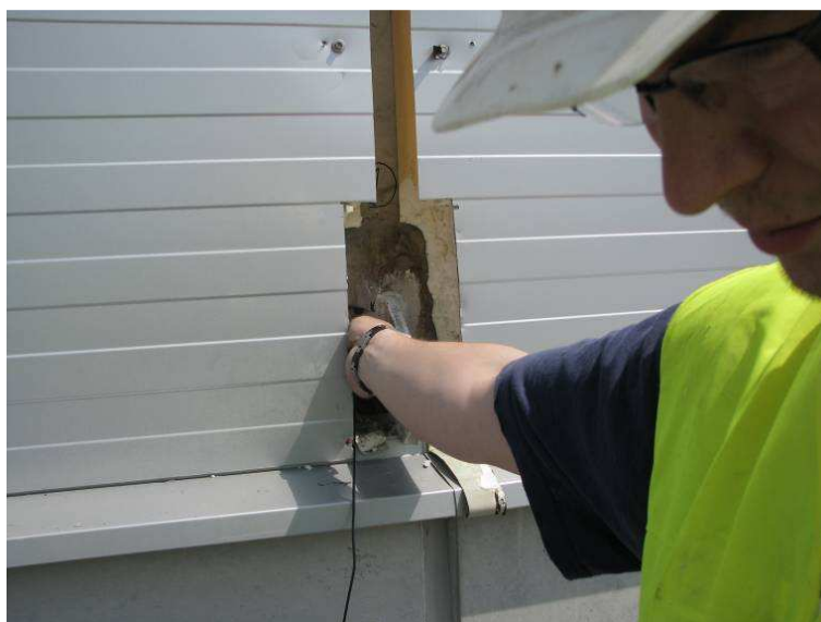
Obr. 22.: Průběh testu kotevních trnů přípojky táhla.
