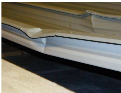
Obr. 7.: Zkoušky střešního pláště – ilustrace mechanismu porušení zkušebního tělesa
