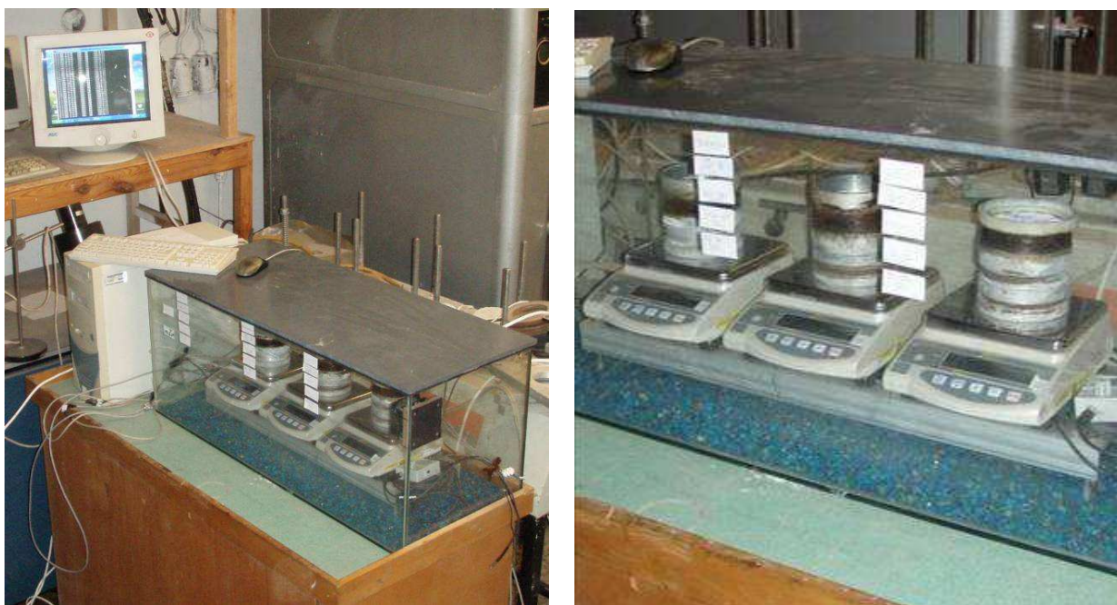
Obr. 1.: Měřicí komora s vloženou sadou tří vzorků, váhícím zařízením a propojením s PC. Vnitřní parametry komory (teplota, relativní vlhkost, barometrický tlak) jsou snímány uvnitř umístěným dataloggerem propojeným s PC.
