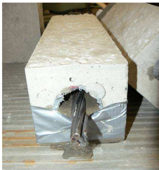
Obr. 3.: Vzorek 4 po simulaci zainjektování, napravo patrná část vzorku 5.
