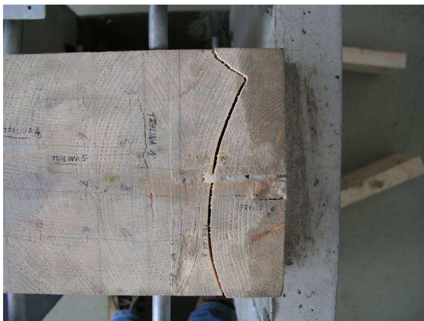
Obr. 5.: Porušení zkušebního tělesa prostým smykem – půdorysný pohled
