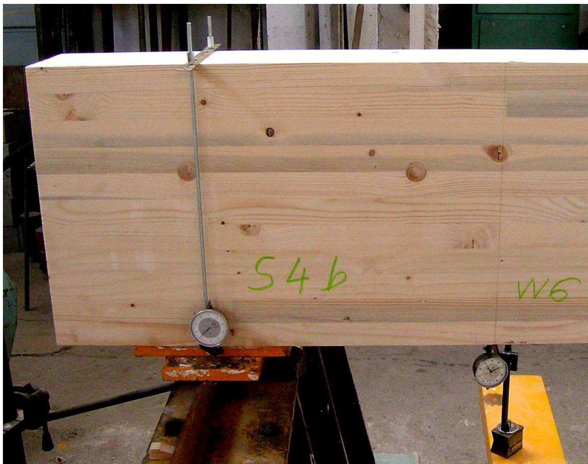
Obr. 5.: Realizácia merania stlačenia prierezu a priehybu pri podpere
