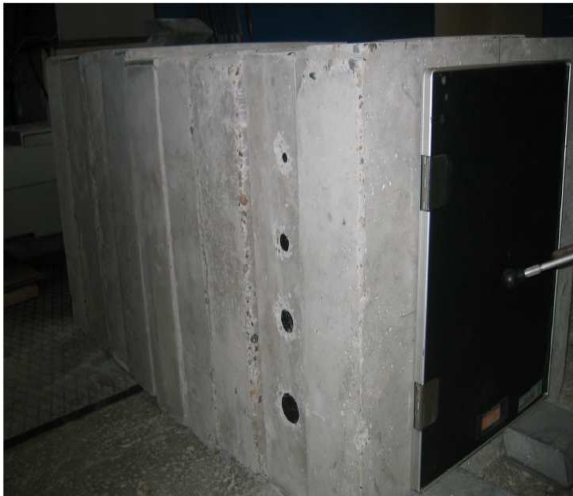
Obr. 3.: Experimentální dráha v Tomsku, na 2. desce patrné konce ocelových výztuží.
