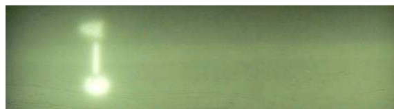
Obr. 7.: Vzorek 1, při tloušťce 600 mm již není snímek reálně vyhodnotitelný.
