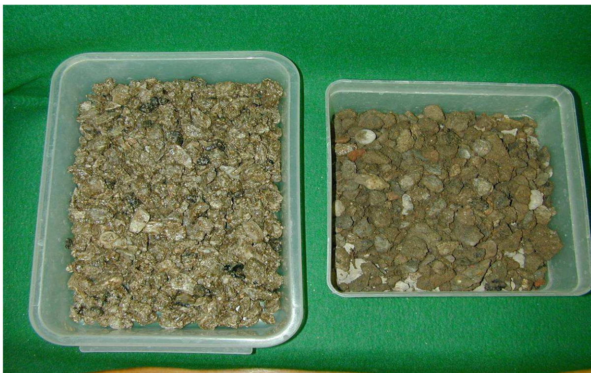
Obr. 2.: Disperzí napenetrovaný a následně aglomerovaný recyklát firmy „Dufonev“ frakce 16-32 mm (původně 0-16 mm) + surový betonový recyklát frakce 0-16 mm
