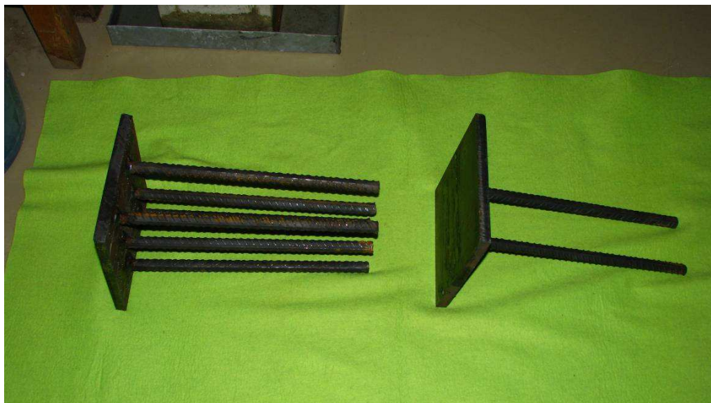
Obr. 19.: Vlevo kotevní deska s projektovým množstvím kotevních trnů, vpravo deska s předpokládaným reálným chybným provedením.
