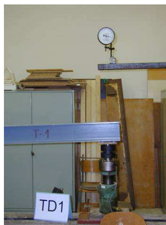
Obr. 9: Realizace zkoušek sloupků pro protipovodňovou stěnu – tělesa TD
