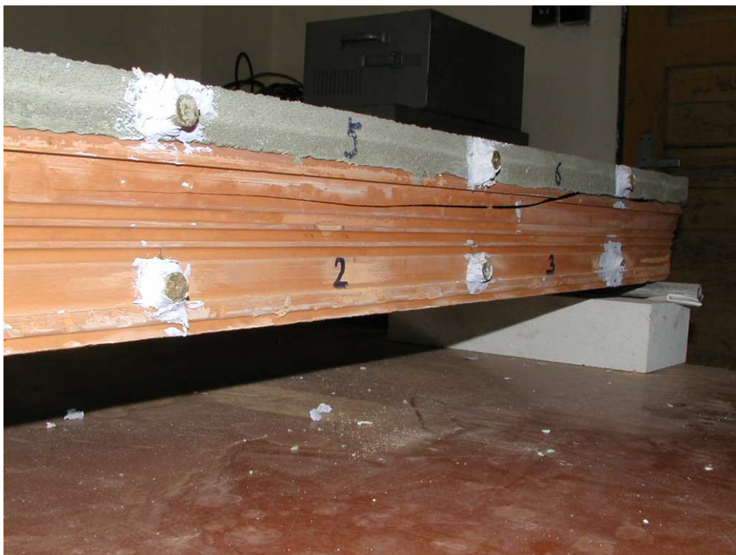
Obr. 2.: Podélná trhлина (experimentální zkoušky)
