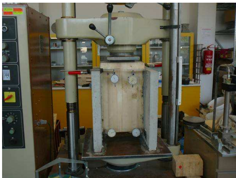
Obr. 3.: Uspořádání zkoušky spřahovacích prvků
