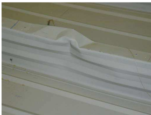
Obr. 7.: Zkoušky střešního pláště – ilustrace mechanismu porušení zkušebního tělesa
