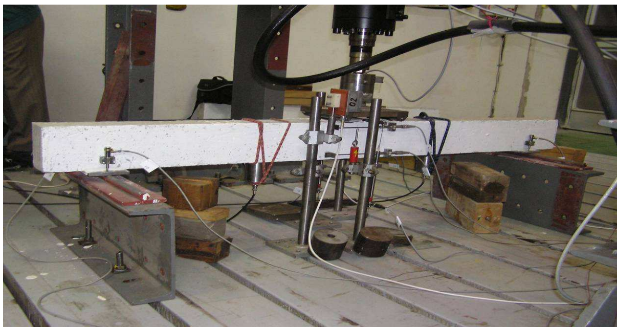
Obr. 1.: Zkušební nosník z vláknobetonu
