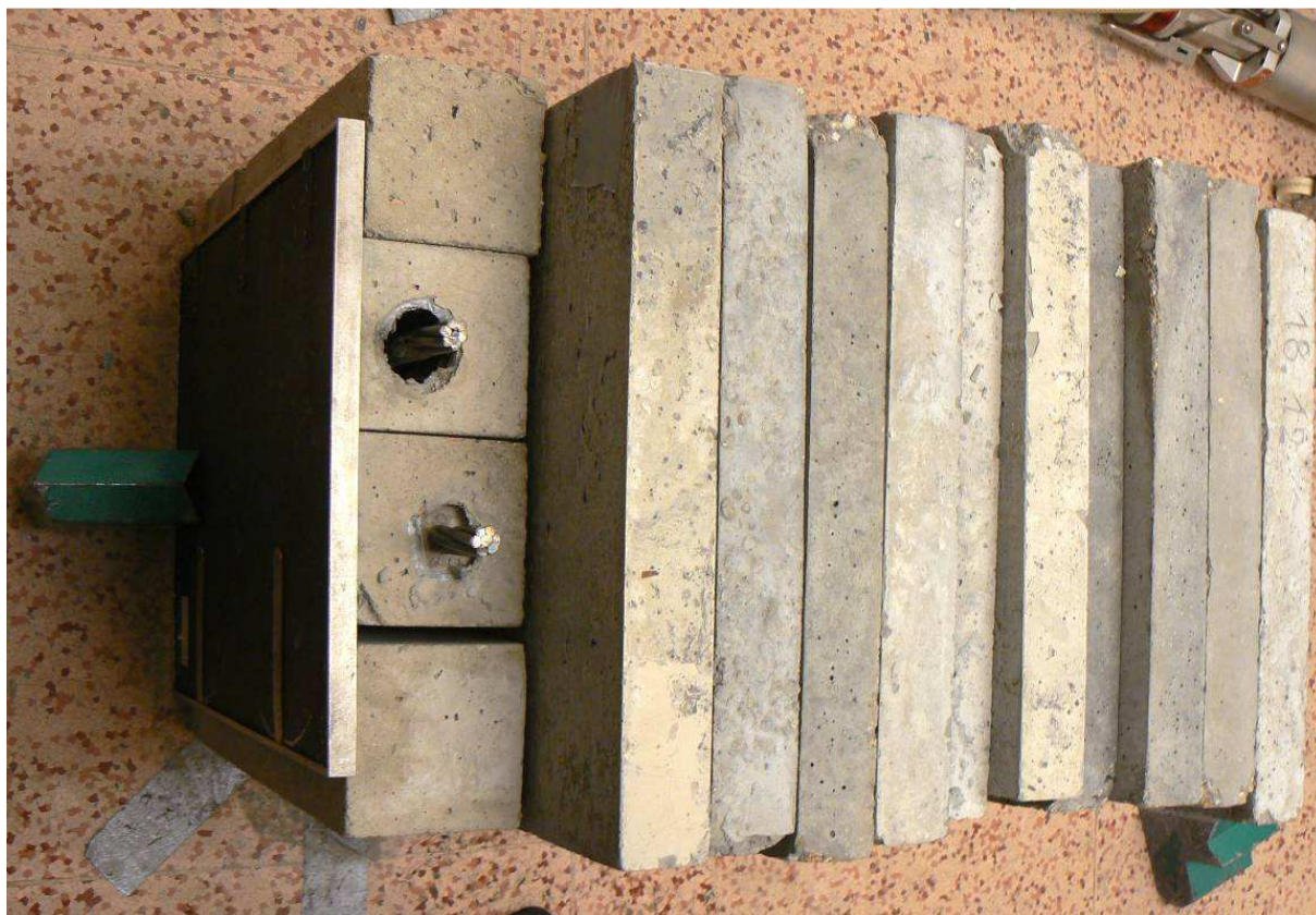
Obr. 4.: Prozařovací dráha při radiografii konfigurace A – 6.
