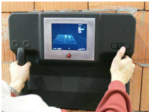
Obr. 9.: ReTWis – radar pro sledování osob za zdí vyvíjený firmou RETIA, a.s.
