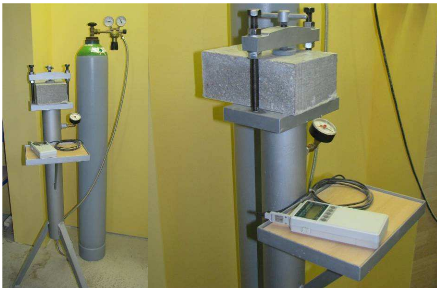
Obr. 7 a 8.: Aparatura pro zkoušení prostupu plynů povrchovými úpravami
