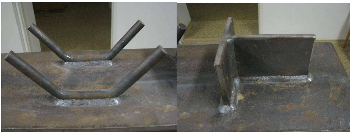
Obr. 15.: Typy kontrolovaných spřahovacích prvků.
