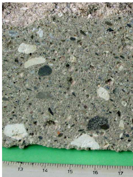
Obr. 2.: Struktura vzorku malty IC z výplňového zdiva mostu v sondě č. 1. Dobře patrné jsou hrudky vápna, barva a tvar zrn písku a jemnozrnná struktura
