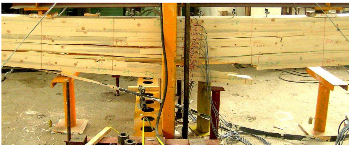
Obr. 12.: Charakteristický finálny kolaps nosníka
