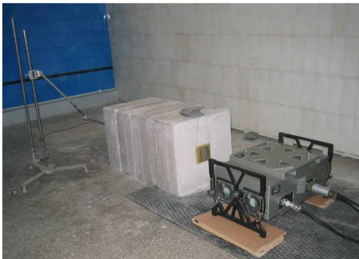
Obr. 4.: Schéma experimentu v Tomsu – betatron MIB-7.5 a experimentální dráha.
