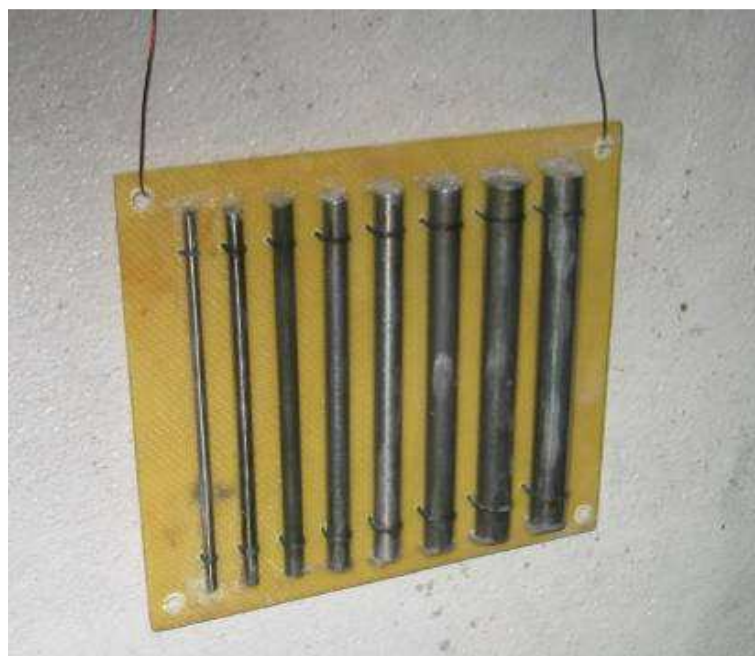
Obr. 5.: Drátová měrka vytvořená dle místních zvyklostí z drátů průměru 3, 4, 5, 6, 7, 8, 9 a 10 mm.
