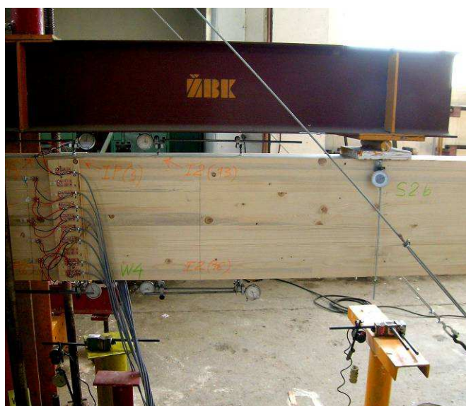
Obr. 3.: Zostava zaťažovacích, kotviacich a meracích prvkov
