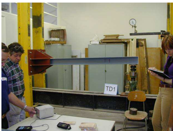
Obr. 9: Realizace zkoušek sloupků pro protipovodňovou stěnu – tělesa TD
