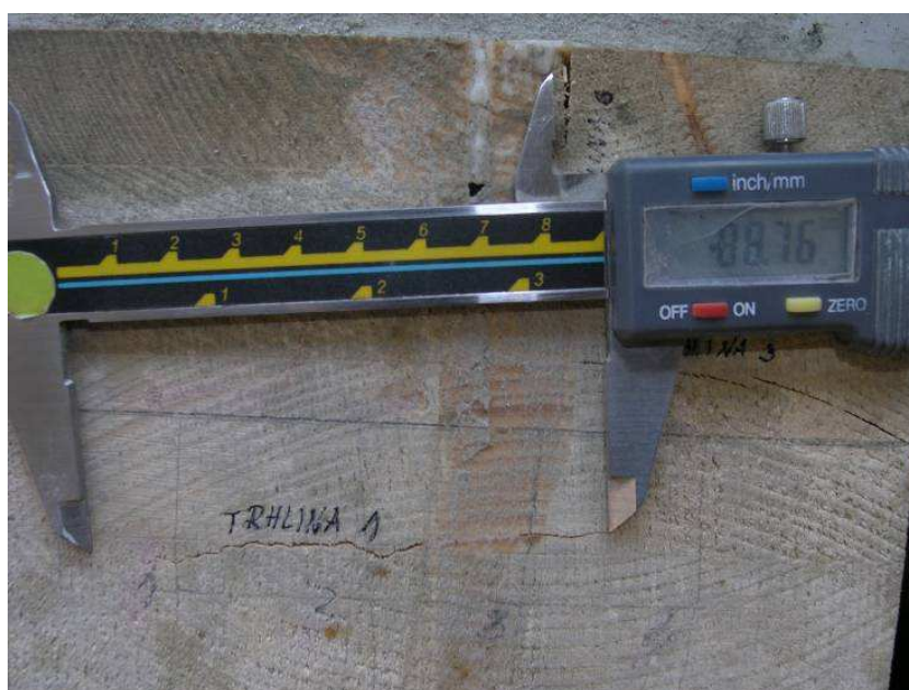
Obr. 6.: Výsušné trhliny ve zkušebním tělese
