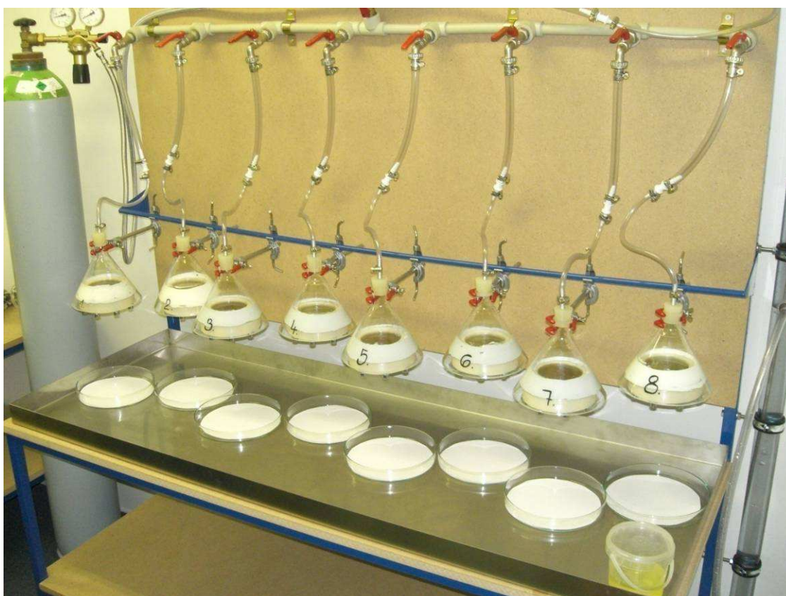
Obr. 4.: Přetlaková testovací aparatura – celkový pohled
