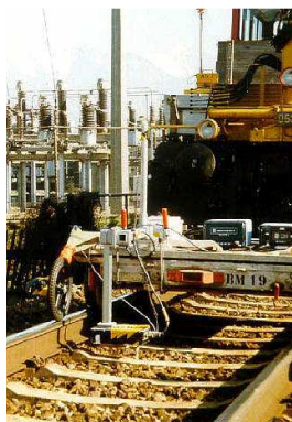
Obr. 7.: GPR pro kontrolu železničního spodku a ukázka změřeného profilu. Převzato z [10]
