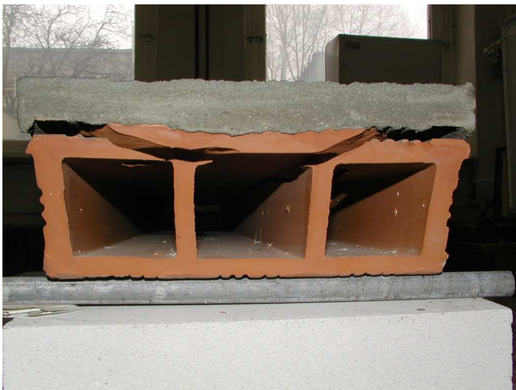
Obr. 3.: Odtržení vložky od vrstvy betonu (experimentální zkoušky)
