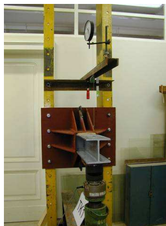
Obr. 10: Realizace zkoušek sloupků pro protipovodňovou stěnu – tělesa TK
