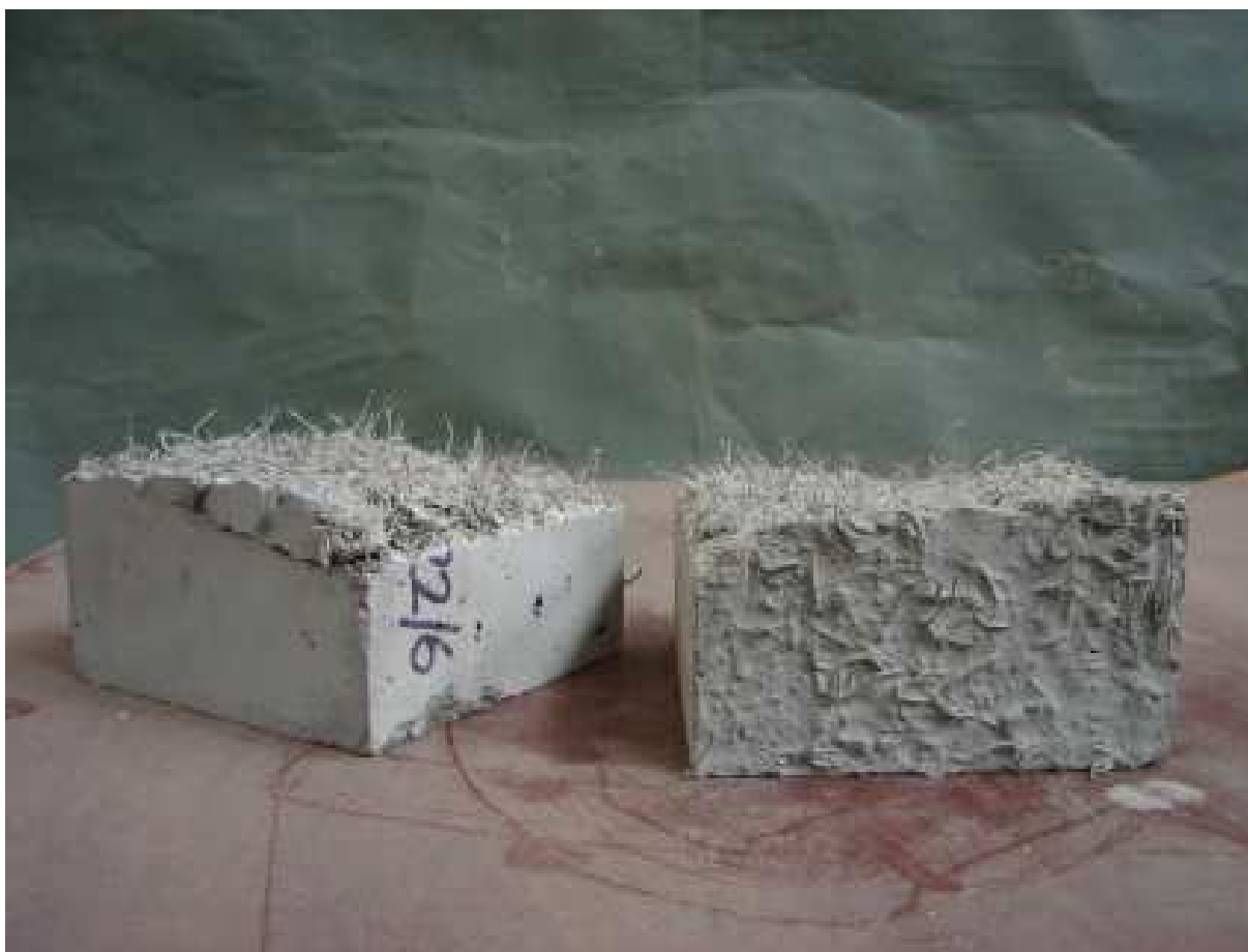
Obr. 3.: Zkušební těleso z vláknobetonu po zkoušce v příčném
