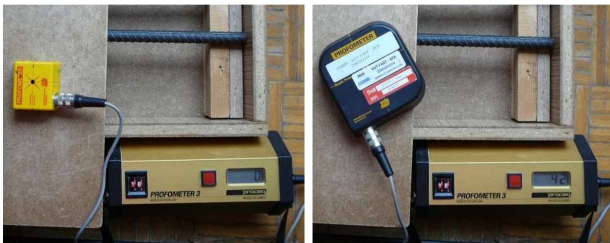
Obr. 1.: Proceq Profometer 3 – vlevo se základní sondou, vpravo s hloubkovou sondou
