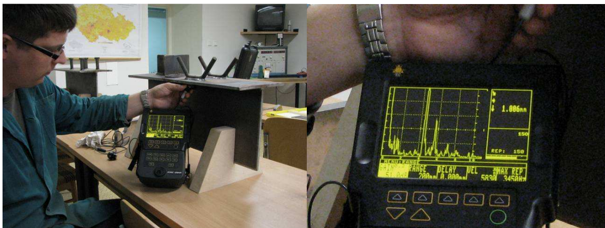
Obr. 17.: Systém zkoušky přítomnosti spřahovacího prvku ze spodního líce nosného prvku s detailem na pozitivní echo nálezu přípoje.
