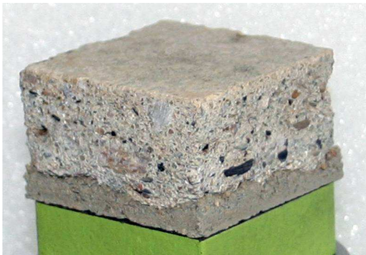
Obr. 12: Vzorek historické malty před tlakovou zkouškou. Protilehlé plochy zkušebního tělesa musí být rovnoběžné, proto byla spodní strana malty vyrovnána nanesením tmelu.
