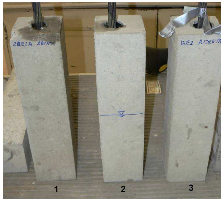
Obr. 2.: Vzorky 1, 2 a 3 po simulaci zainjektování.
